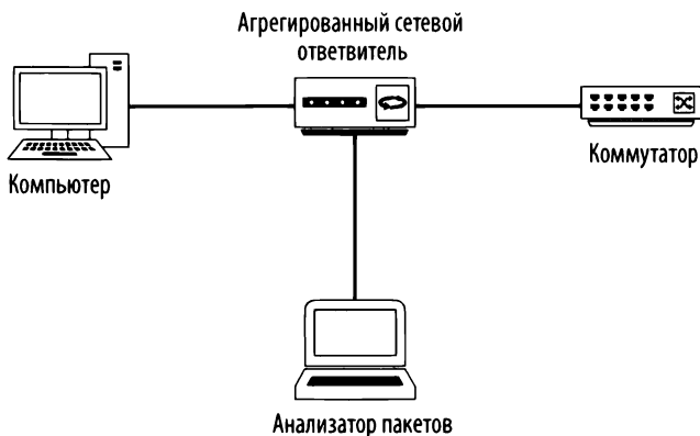
Рис. 2.8. Применение агрегированного сетевого ответвителя для перехвата сетевого трафика
